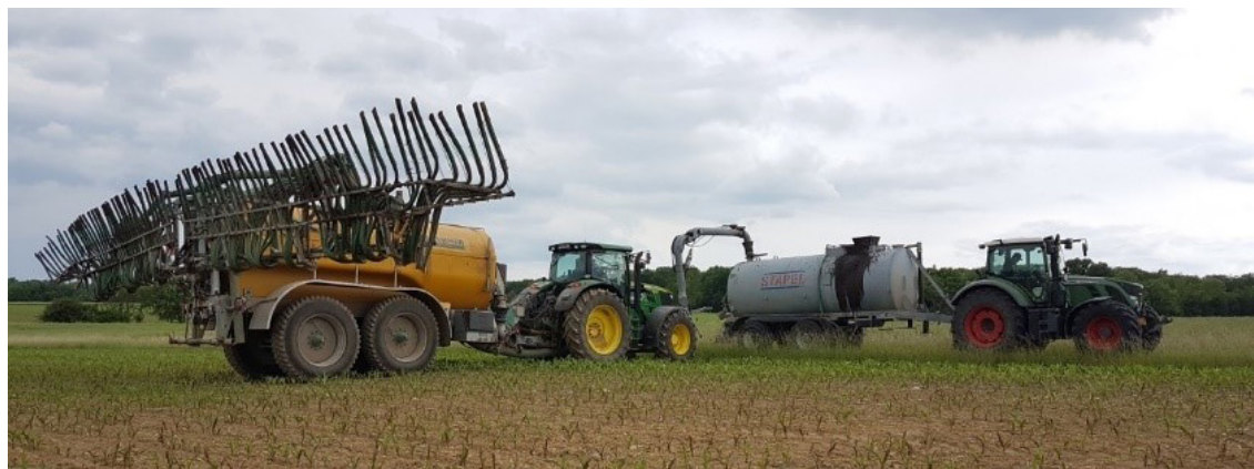
❶ Рис. 11: Перекачка жидкого навоза из транспортного резервуара в бочку распределителя.
