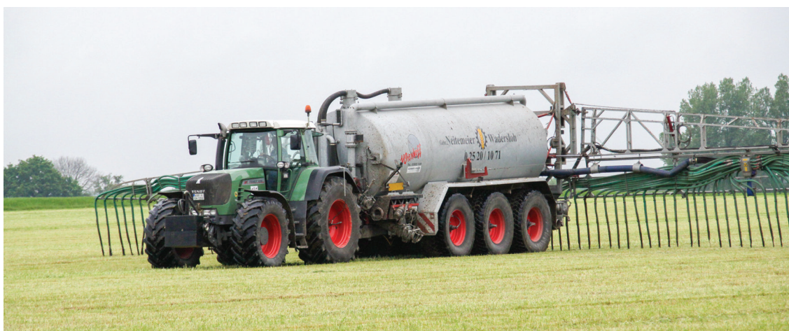
❷ Рис. 16: Трактор со шланговой системой поверхностного нанесения.
